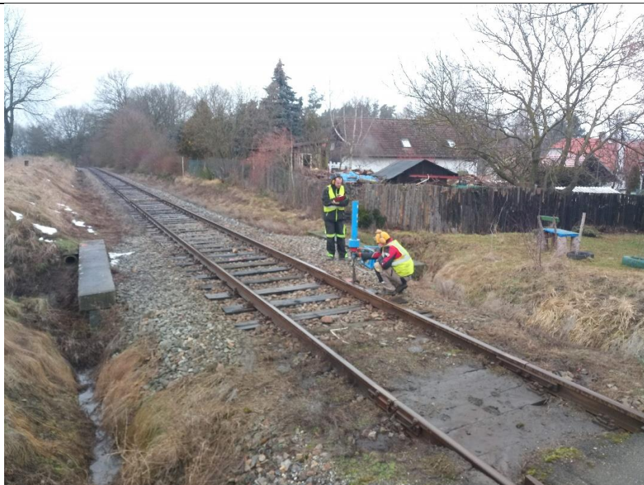
Foto 4: Střední dynamická penetrace DPM3
