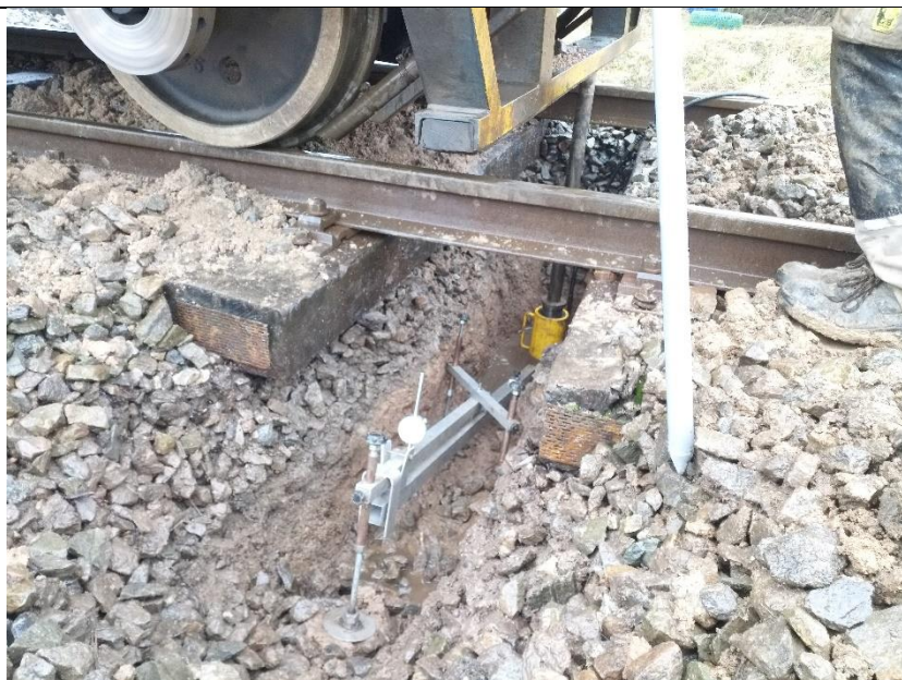
Foto 3: Statická zatěžovací zkouška deskou ZZB3
